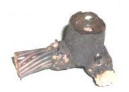
ALTURA EXCESIVA, APARIENCIA DE BURBUJA, SOLDADURA PROBRE.
